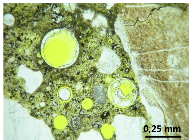
Bild 3.74: Beton 8, Einwirkung KAc-Lösung (8 Zyklen KWL), Kernbereich: Poren mit AKR-Gel neben gerissem Kieselschieferkorn, einfach Pol.
