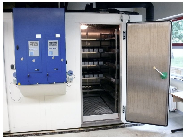
Bild 2.66: Blick in eine geöffnete Klimasimulationskammer (Feutron, Typ 3705/04) am Finger-Institut
