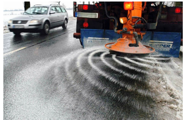
Bild 3.4: Auftrag von Feuchtsalz auf NaCl-Basis auf eine Fahrbahndecke [223]
