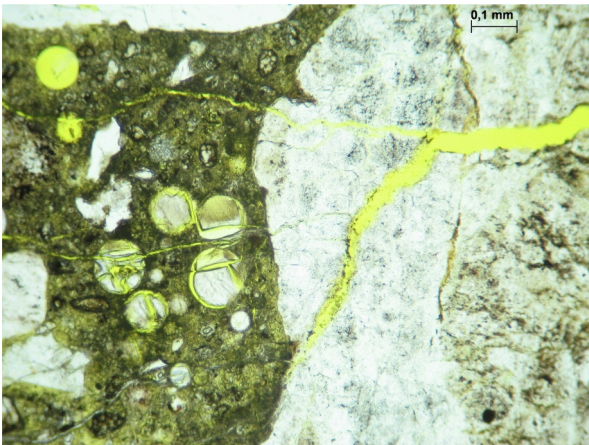
Bild 6.11: Betonzusammensetzung BAB A9 (nachgestellt) mit Sand/Kies aus Saale-Vorkommen nach FIB-Klimawechselagerung (12. Zyklus) unter Einwirkung der NaCl-Lösung, Mikroriss in Kieselschieferkorn aus dem Kies und AKR-Gel in angrenzenden Poren, einfach Pol.
