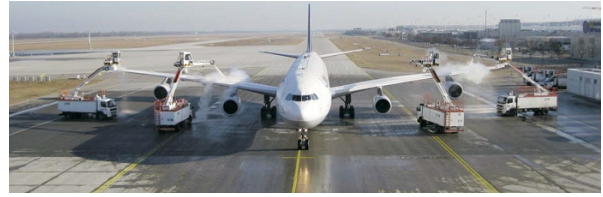
Bild 3.6: Enteisung eines Flugzeuges mit Flugzeugenteisern auf Basis von Propylenglycol [232]
