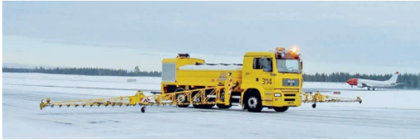
Bild 3.5: Enteisung der Flugbetriebsflächen eines Flughafens mit Bewegungsflächenenteisern auf Basis von Alkaliacetaten und -formiaten [231]
