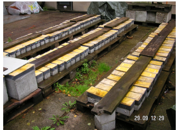
Bild 2.68: Außenlagerfläche mit abgehauten Balken (100×100×500 mm) und Würfeln (300×300×300 mm) im Innenstadtbereich von Weimar
