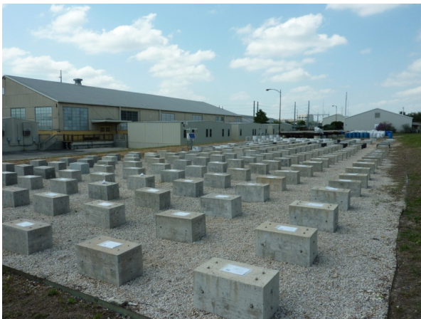
Bild 2.67: Großflächiges, im Jahr 2001 eingerichtetes Außenlager mit Betonblöcken (380×380×720 mm) auf dem Gelände der Universität von Texas in Austin
