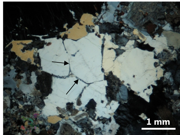
Bild 6.14: Quarzkorn im Granodioritgefüge mit Mikrorissen (Pfeile), \times Pol.
