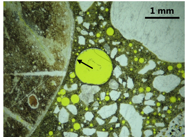
Bild 3.70: Beton 8, Einwirkung H_2O (8 Zyklen KWL), Kernbereich: Pore mit Spuren von AKR-Gel (Pfeil), einfach Pol.
